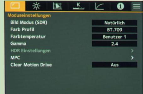
„Moduseinstellungen“ bietet Zugriff auf Farbprofile, Helligkeit, Farbtemperatur, Gamma sowie den „Clear Motion Drive“.
