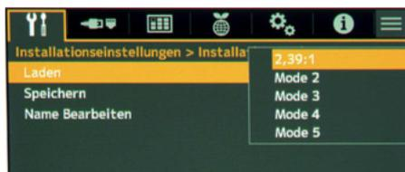
**Lens-Memory:** Im Installationsmenü können Bildgröße, Lage, Fokus, Konvergenz, Zoom und die Maskierung eingestellt sowie gespeichert werden.
